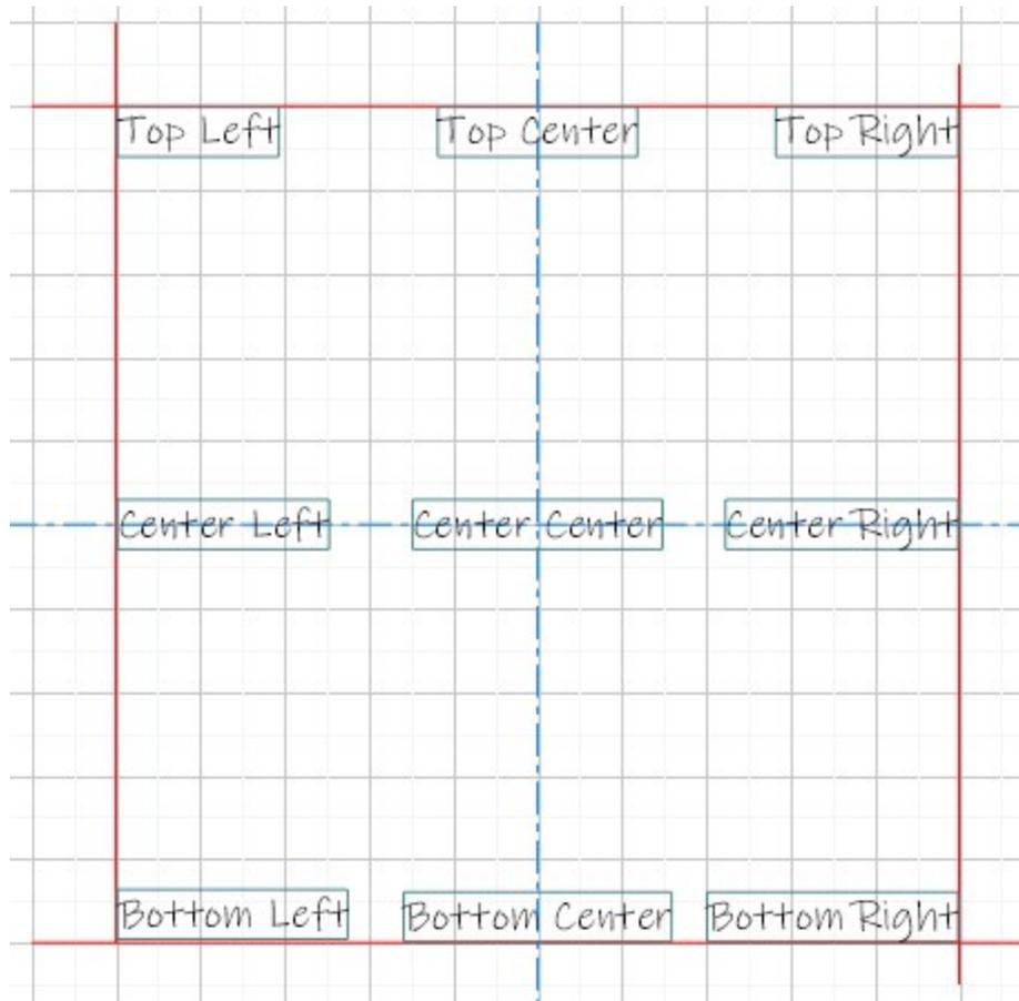
**Fig.51** Align Text (angle 0°)
